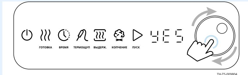
Появится значок START. Индикатор вокруг регулятора начнет мигать. Дисплей будет пустым в течение нескольких секунд. Отобразится версия программного обеспечения интерфейсной платы (IB). Отобразится версия программного обеспечения платы управления (CB). Запишите этот номер.
