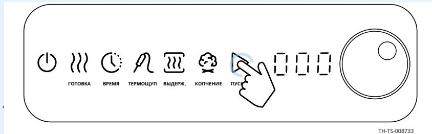
На панели управления отобразится «Pre», после чего отобразится значение фактической температуры в камере.
